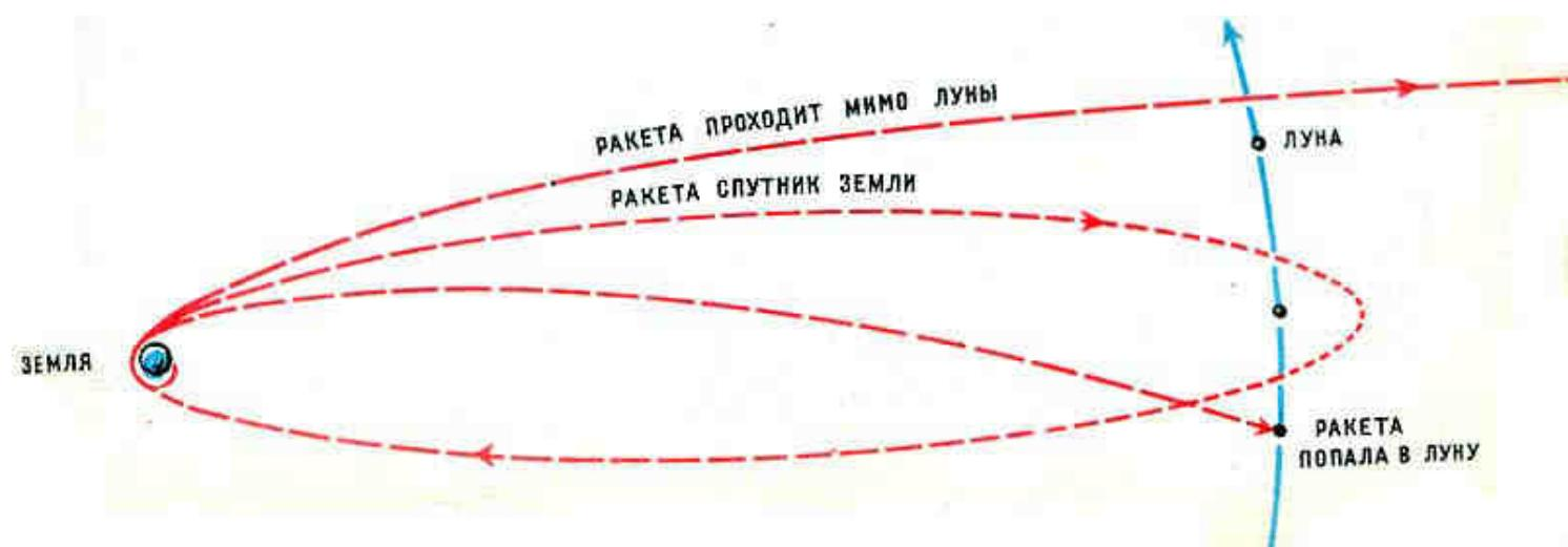
Ракетой, управляемой только при разгоне, можно, как вы уже знаете, и попасть в небесное тело. Только плавно посадить ее на его поверхность уж никак нельзя. Поэтому посыпать на Луну и планеты в таких ракетах хрупкие приборы нет смысла — разбоятся.
